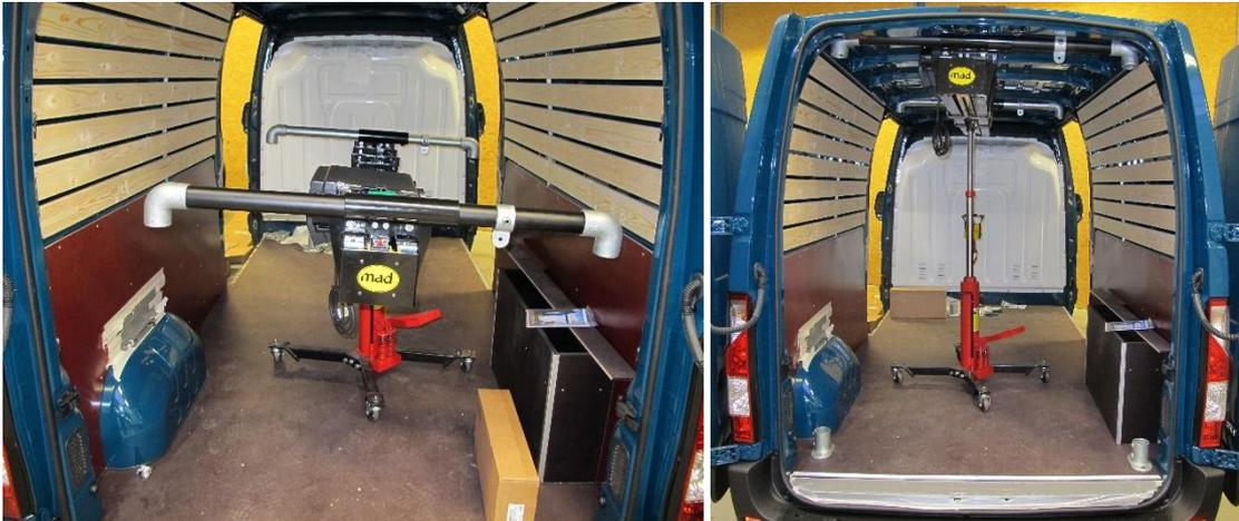
12. Stellen Sie den Ständer auf der linken Rückseite in einen Sockel. Schieben Sie dann einen Befestigungsring um den Ständer. Schieben Sie dann den Ständer in das 90-Grad-Knie des hinteren Trägers.
